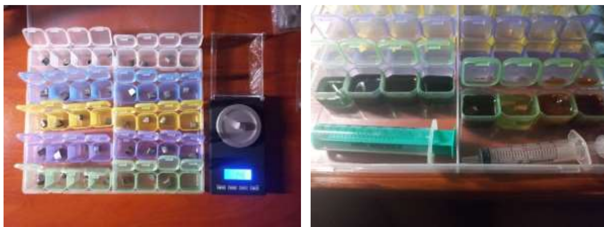
Рис. 2.8 – Загальний вигляд зразків під час проведення корозійних випробувань: а – зважування зразка на електронних вагах; б – витримування зразків у корозійних середовищах
